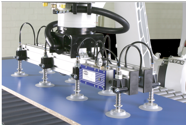
Пример монтажа пружинных плунжеров FSTF
